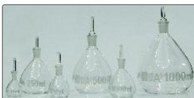
Picnómetro (Botella para Gravedad Específica), con tapón capilar
