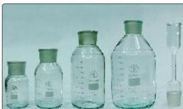
Picnómetro (Tipo Botella), con doble tubo capilar tipo embudo
